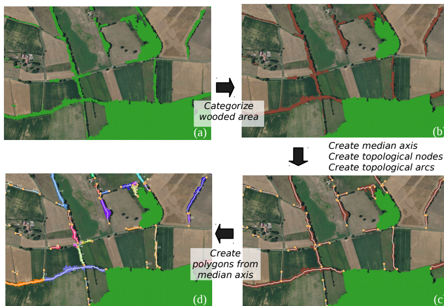
FIGURE 4. Outils de préparation des données de HedgeTools permettant, à partir d'une couche d'éléments arborés (a), d'en extraire les haies (b), d'en dériver les axes médian et le graphe topologique (c) et de redécouper les emprises (d).
