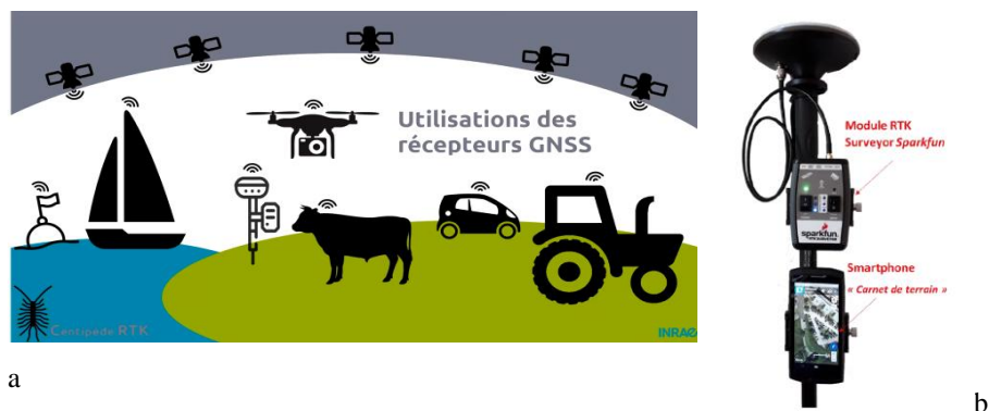
FIGURE 4. Différents types de rover en fonction des cas d'utilisations (a) et rover Sparkfun équipant une canne (b).
