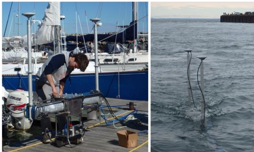
Figure 1 : Porteur hydrographique tracté avec sondeur Reson Seabat T20P.
